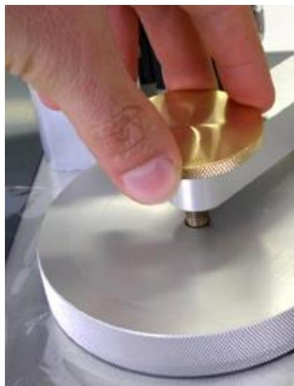
PermeH<sub>2</sub>O è conforme alle norme ASTM F1249, TAPPI T557, JIS K-1729 e ISO 15106-2 per la determinazione della WVTR attraverso film e materiali plastici usando un sensore infrarosso.
